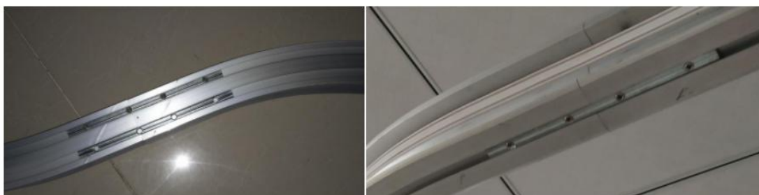
每两根轨道的接缝处通过3根一字条拼接在一起，上面两根下面一根
